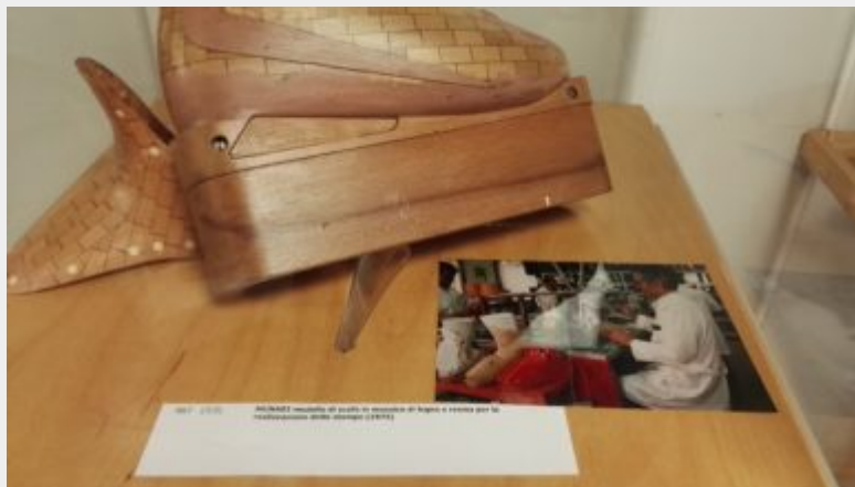
Fig. 4 - Modello di scafo in mosaico di legno e resina per la realizzazione dello stampo di uno scarpone da sci, 1975, esposto al Museo dello scarpone e della calzatura sportiva di Montebelluna / © Museo dello scarpone e della calzatura sportiva, Villa Zuccareda Binetti, Montebelluna.
