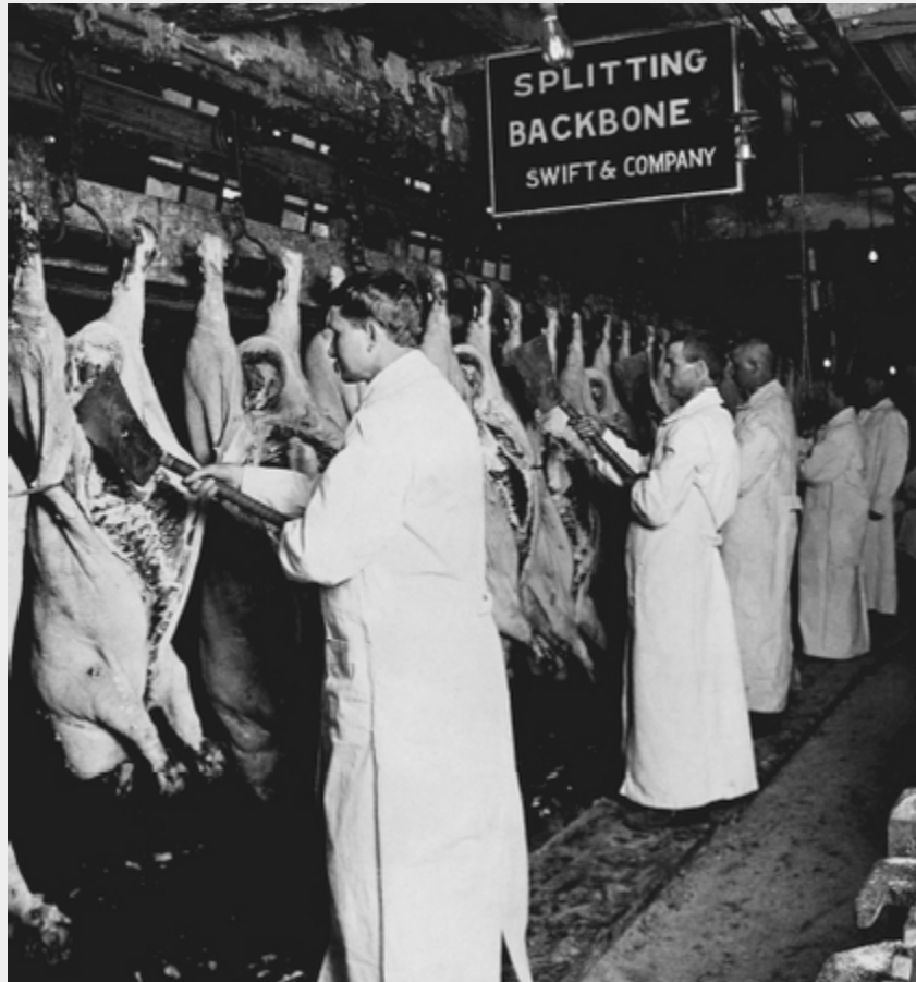
Fig. 2 - Swift & Company's Meat Packing House, Chicago, Illinois, 1910-1915. Processo di Splitting Backbones and Final Inspection of Hogs dopo l'applicazione del "Meat Inspection Act" emanato dal Congresso US nel 1906. Tratta da: http://collections.thehenryford.org/ .
